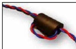
Рисунок 5. Жилы можно также обернуть через ферритовый сердечник для понижения различных частот. Оптимальное количество петель зависит от конкретного применения и частот, вызывающих помехи
