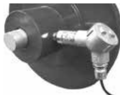
Рисунок 2. Стандартная установка передатчика
