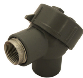
Gehäuse für Schutzrohr-Anschluss aus kupferfreiem Aluminium (alle Modelle außer AAA=005) Gehäuse für Schutzrohr-Anschluss aus 6061-T6 Aluminium, das als meerwasserbeständiges Aluminium gilt und mit Epoxidpulver beschichtet ist.
