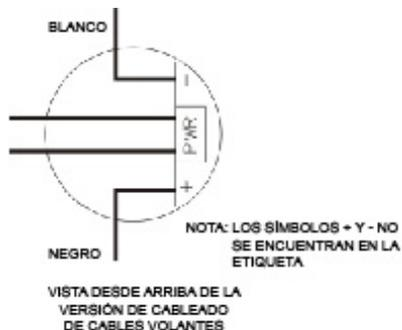
Figura 6: Vista desde arriba de las conexiones de salida dinámica opcionales en los transmisores con cables volantes
