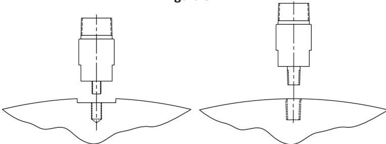
El estilo de rosca mecánica requiere una superficie preparada (torneada) para el contacto con la base
