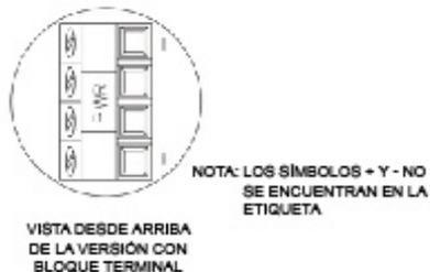
Figura 7: Vista desde arriba de las conexiones de salida dinámica opcionales en los transmisores con bloques terminales
