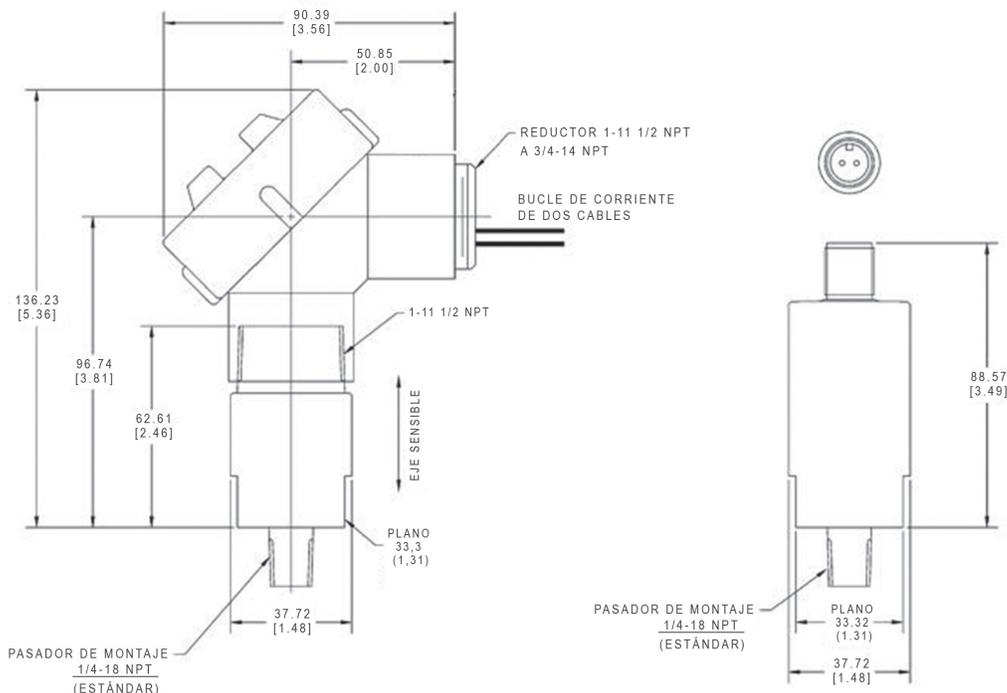
**Figura 1:** Dimensiones del esquema del ST5484E (todas las versiones, excepto el conector estilo MIL). Dimensiones en mm [pulgadas] Se muestra el codo de conducto 8200-001 opcional\* instalado.
