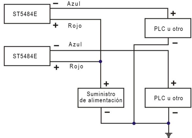
**Figura 4:** Instalación típica para un transmisor de vibración sísmica múltiple ST5484E
