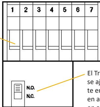
El Triac o interruptor analógico se ajusta en forma independiente en el campo, para abrir (N.C.) en alarma o para cerrar (N.O.) en alarma.
