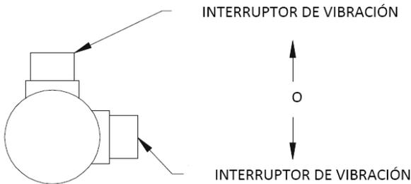
La mejor manera de elegir la dirección de montaje es midiendo el nivel de vibración en ambas direcciones con un metro de vibración (tal como el Metrix 5500) y elegir la dirección con el nivel más alto. Esto generalmente será horizontal, ya que la estructura de la máquina por lo general es menos rígida horizontalmente que verticalmente .
