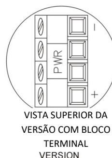
Figura 5 – Vista superior mostrando as conexões da saída dinâmica opcional em transmissores com blocos terminais.
